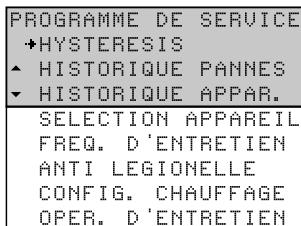
2. Appuyez sur la flèche bleue (
