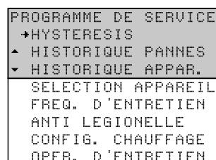
5. Appuyez sur la flèche bleue () pour mettre le pointeur devant CONFIG. CHAUFFAGE puis appuyez sur ENTER. L'afficheur se présente comme illustré sur la figure.
